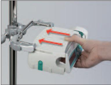
1. Die Pumpe mit den Führungsschienen der Polklemme ausrichten.
